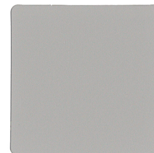
RA020 SCプリントグレー 日射反射率: 49%
