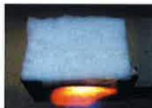
ガラスを原料としたアクリアは、燃えにくく高温に強いので、万一の火災時にも延焼や類焼の被害を最小限に抑えることができます。万一燃えても、煙や有毒ガスは発生しません。
