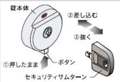
従来のサムターン セキュリティサムターン(取り外した状態)
